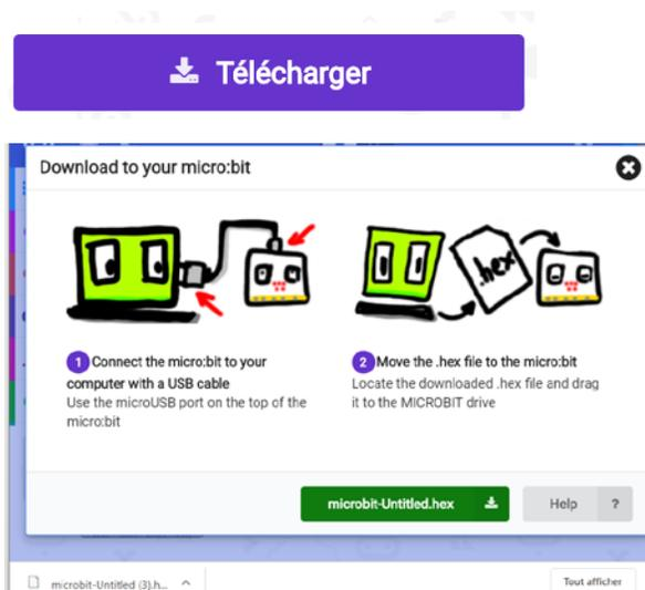
6. Branche le micro:bit au portable à l'aide du fil USB et transfère le fichier .hex au micro:bit.
